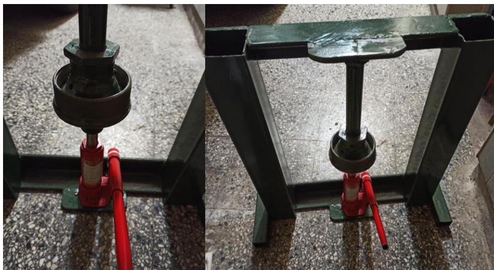
Figura 1. Prensa para la extracción del aceite de las semillas de ricino
