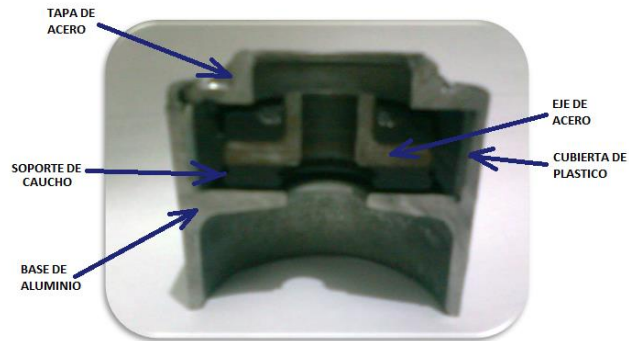
Figura 4. Componentes de la base del amortiguador. Fuente: Diaz, G. F. & Jimenez, J. 2011
