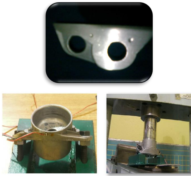
Figura 8. Pruebas de dureza y extensometría. Fuente: Diaz, G. F. & Jimenez, J. 2011
