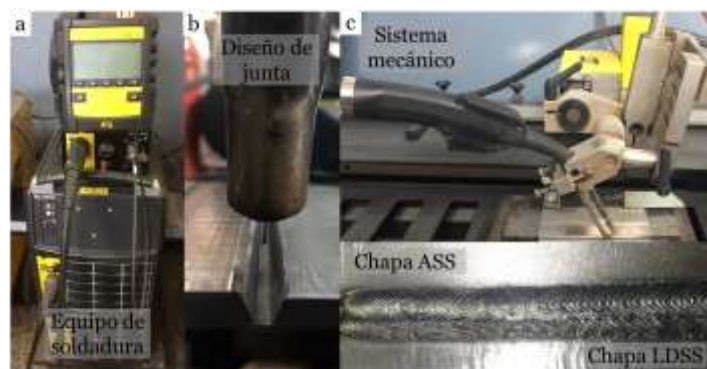
Figura 3 – a: equipo; b: diseño de junta; c: sistema mecánico
