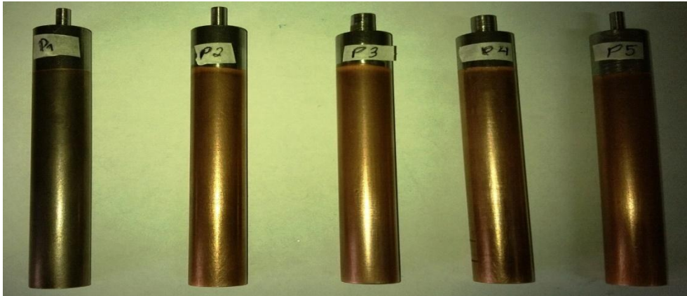
Fig. 9. Recubrimiento electrolítico de cobre, sobre barras de acero al carbono. Fuente: Cortez K. 2014.
