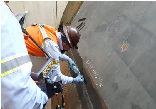
Figura 9. Inspección de fondo con PAUT Fuente: archivos SIE-INDESA 2019.
