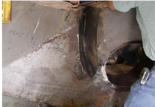
Figura 1. Preparación de la pieza para su reparación. Fuente: Aguilar R. y Soria L. 2008.
