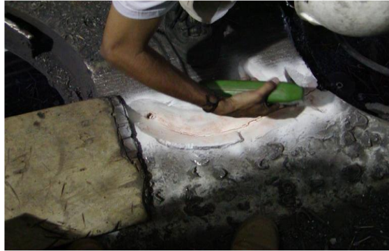
Figura 6. Monitoreo con partículas magnéticas, yunque manual. Fuente: Aguilar R. y Soria L. 2011.
