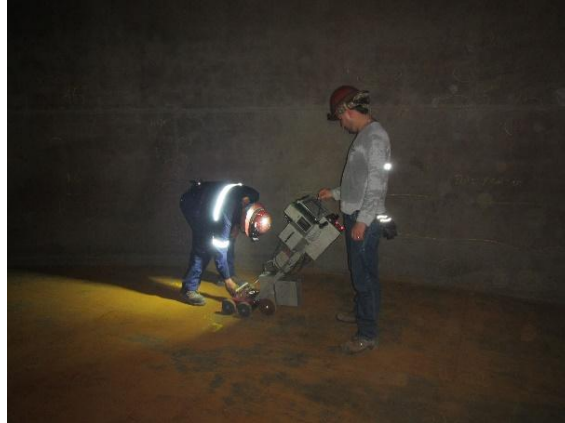
Figura 12. Inspección de fondo con MFL. Fuente: archivos SIE-INDESA 2019.
