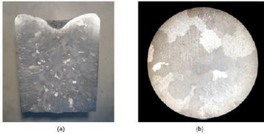
Fig.11. – Al-3% Cu - Corte transversal, 20X.
