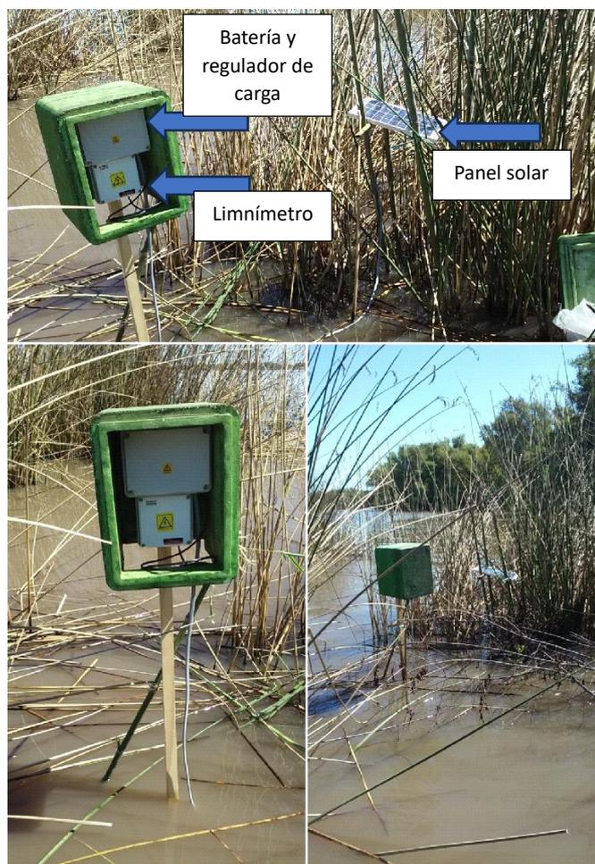
Figura 2 – Instalación del limnómetro en el Embalse Ing. C. Roggero – Lago San Francisco (Moreno, provincia de Buenos Aires)
